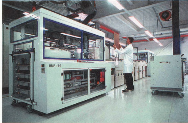
Anlage zur chemischen Oberflächenbehandlung von Leiterplatten bei der Varioprint AG (2006).
