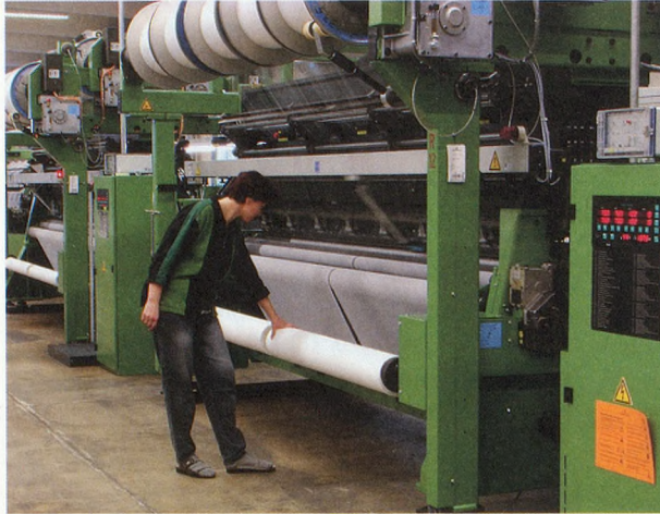
Eine der hochmodernen Kettenwirk-Maschinen, die bei Eschler im Einsatz stehen (2002).
