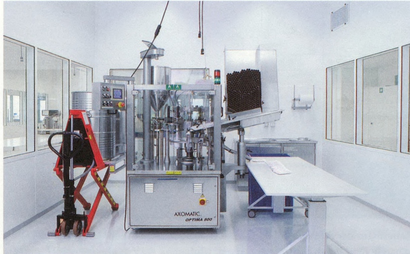
Tubenabfüllanlage Axomatic Optima 800 (2006). Die Abfüllung von Tuben erfolgt bei der Hänseler AG in Reinräumen. Die Anlage kann maximal 60 Tuben pro Minute verarbeiten. Die Tubenvolumina variieren zwischen 3 und 250 Milliliter.
