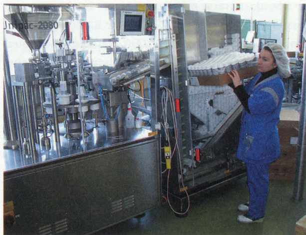
Moderne Tubenabfüllanlage bei der Ulrich Jüstrich AG. Die vollautomatische Abfüllung unter Reinraumbedingungen garantiert höchste Qualität.
